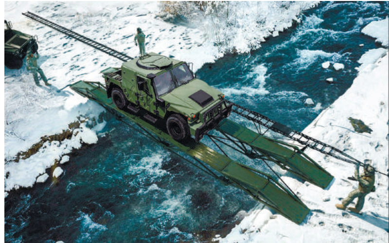
Система «EasiBridge» задействованная в переправе крупногабаритного военного транспорта через водное препятствие. Источник: ThinkDefense
