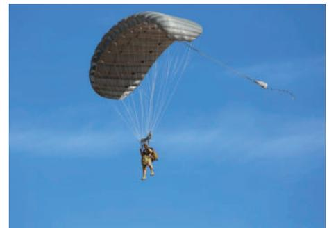
Еще одна относительно новая американская парашютная система — Hi-5, разработанная Airborne Systems North America. Граница применения по высоте — до 7600 метров над уровнем моря. Был представлен и доработанный вариант па-
