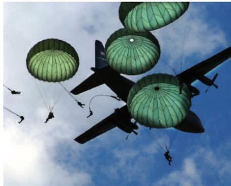
Имеет классическую округлую форму. В зависимости от плотности воздуха и общего веса парашютиста, средняя скорость парашюта составляет от 6,7 до 7,3 м/с; общее ограничение веса составляет 360 фунтов (160 кг). Вся сборка весит 31 фунтов (14 кг). Купол имеет полюсное отверстие, а также отверстия в задней части. По расчетам американских экспертов, нормальное функционирование основной парашютной системы обеспечивается с вероятностью не ниже 0,75-0,80.
